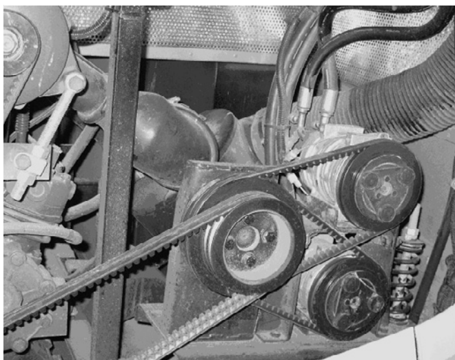
Abb. 1 Buseinbau mit 2 x 170 ccm PKW-Verdichter
